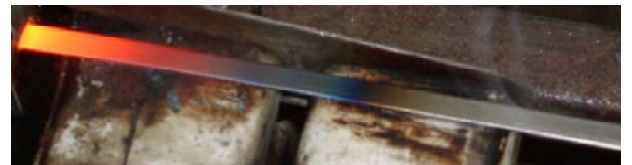
Рис. 3. Розжарювання рухомої смуги в момент її відпалу електричним струмом
