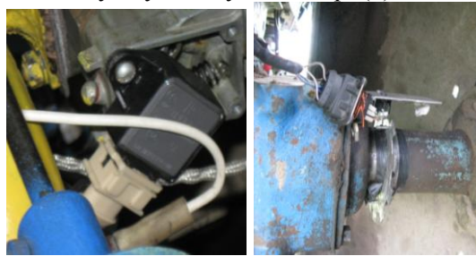
Рис. 2 . Датчик положення дросельної заслінки (а) і датчик частоти обертання колеса
