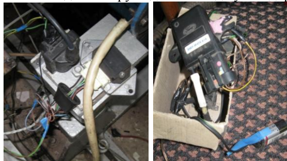
Рис. 1. Комутатор запалювання (а) і датчик розрідження у впускному колекторі (б)
