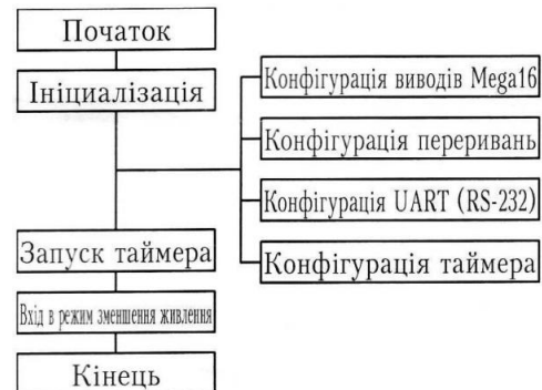
Рис.5. Алгоритм роботи мікроконтролера АТМega16 для вимірювання інтервалів часу
