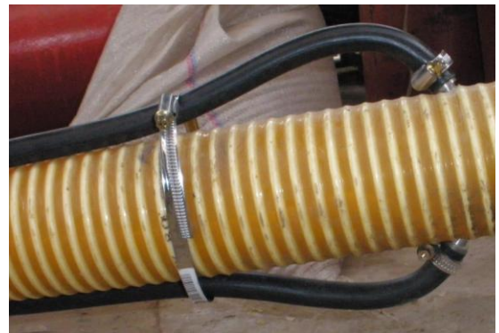
Рис. 3. Під'єднання шлангів пневмосистеми до гнучкого транспортного рукава
