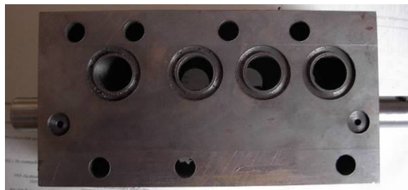
Рис.4. Загальний вигляд золотника з борохромовим покриттям та корпусу.
