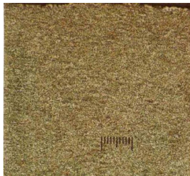
Рис. 3. Микроструктура покрытия «Ni-Cr», полученного сверхзвуковым газопламенным напылением (шкала, мм)
