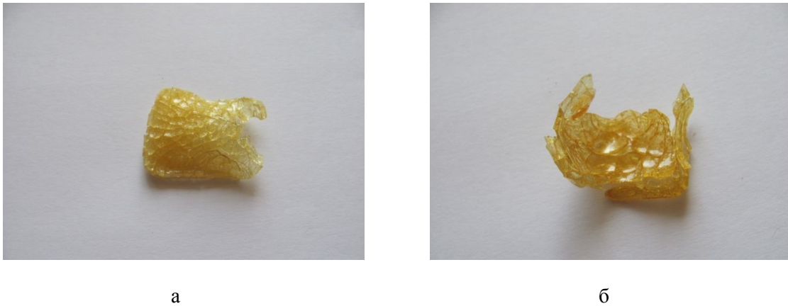
Рисунок 2 Загальний вигляд зразків після екстрагування: а – СВЧ обробка; б – ступінчаста обробка
