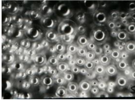
Рис. 1. Полые стеклянные микросферы, x 200
