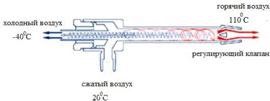
Рис. 2. Устройство вихревой трубки
