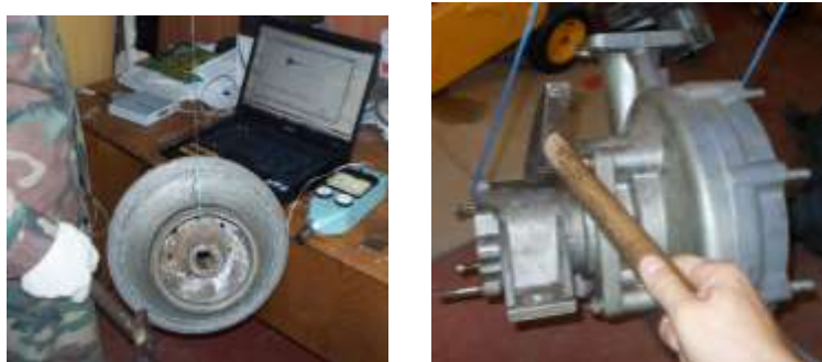
Рис. 3. Фото з проведення тесту на збудження вільних коливань в робочому колесі та корпусі насосу при збудженні різних форм коливань імпульсом
