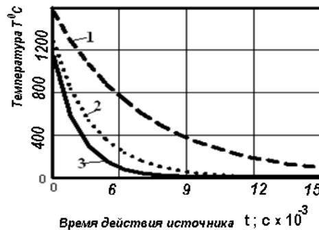
Рис. 3. Закономерность охлаждения произвольной точки произвольного сечения на поверхности полубесконечного тела после прекращения действия источника тепла. Материал сталь X15H6; 1 - V_{II} = 10 м / мин; 2 - V_{II} = 20 м / мин; 3 - V_{II} = 30 м / мин. Круг Э9А16СМ1К5. v_{кр} = 30 м / с; t = 0,03 мм
