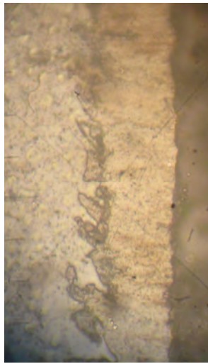
Рис. 5. Мікроструктура КЕП з нановключеннями VN після термічної обробки, \times 500
