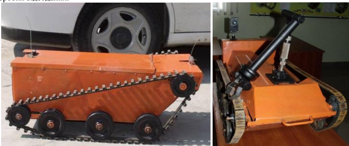
Рис. 3. Експериментальні прототипи пожежних роботів
