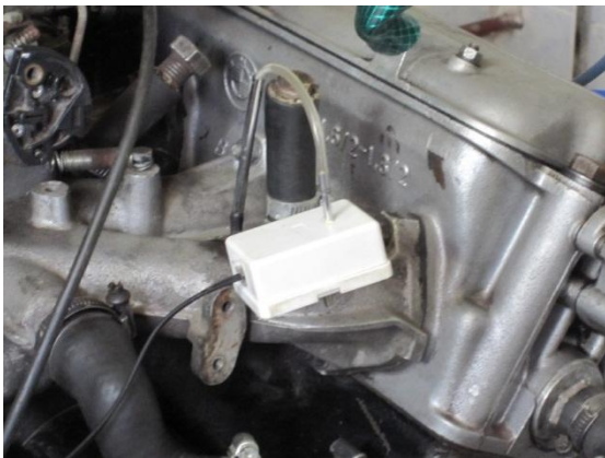
Рис. 7. Загальний вигляд датчика тиску при вимірюванні
