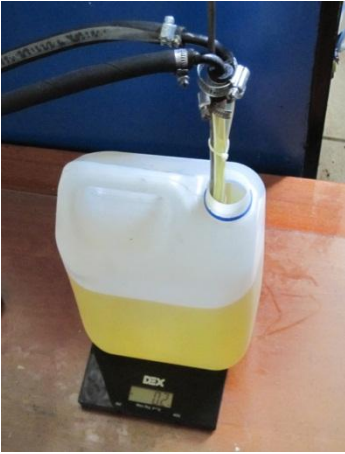
Рис. 5. Система для визначення витрати палива ваговим методом
