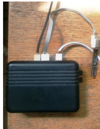
Рис. 8. Модуль програмно-апаратного комплексу для дослідження динамічних характеристик двигуна внутрішнього згоряння на основі МК ATmega16
