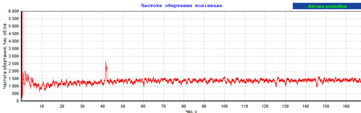
Рис. 10. Осцилограма зміни обертів колінчастого вала n на режимі холостого ходу при змінних значеннях тиску наддуву P_k
