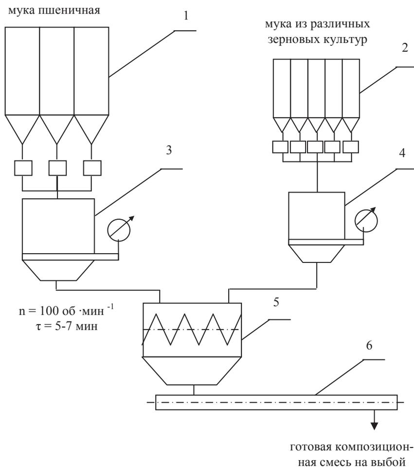
1, 2 – наддозаторные бункера; 3, 4 – весовой дозатор; 5 – смеситель периодического действия; 6 – конвейер
