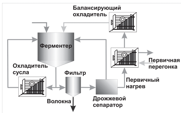
Рис. 3 – Схема установки теплообменников в процессе непрерывно-поточного метода ферментации
