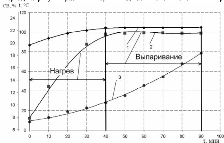
1 – температура поверхні РТС; 2 – температура продукту; 3 – концентрація сухих речовин Рис. 2 – Зміна концентрації сухих речовин і термограми при випарюванні яблучного пюре, n = 14 об/хв, \gamma = 30^\circ
