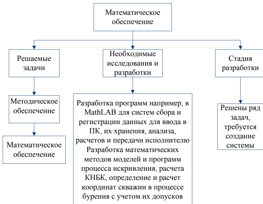
Рис. 2. Схема системы «направленное бурение» – Математическое обеспечение
