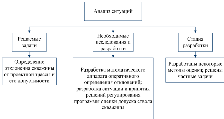
Рис. 5. Схема системы «направленное бурение» – Анализ ситуаций
