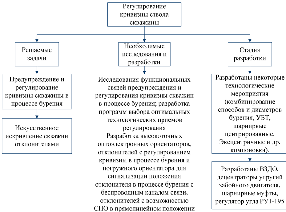
Рис. 5. Схема системы «направленное бурение» – Анализ ситуаций
