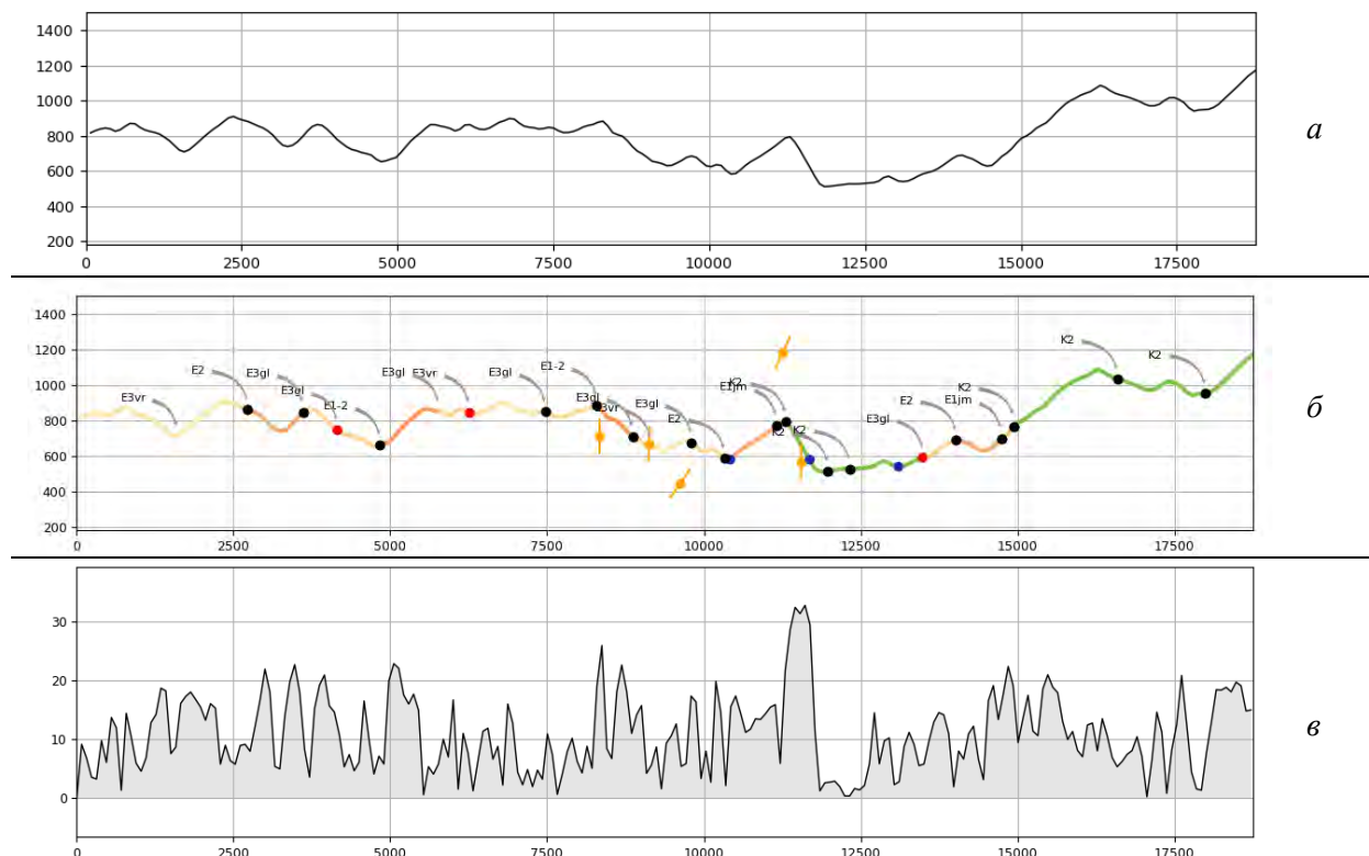
Рис. 3. Приклад побудови топографічного профілю (а), геологічного профілю (б) з нанесенням геоданих (точками показані геологічні межі) та профілю, що вказує на крутизну схилів у градусах (в) за допомогою модуля qProf у програмі QGIS для лінії, що вказана на рис. 2
