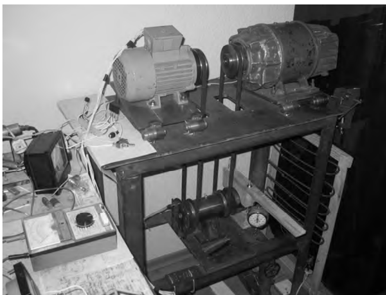
Рисунок 5 – Стенд для измерения электромагнитного момента
