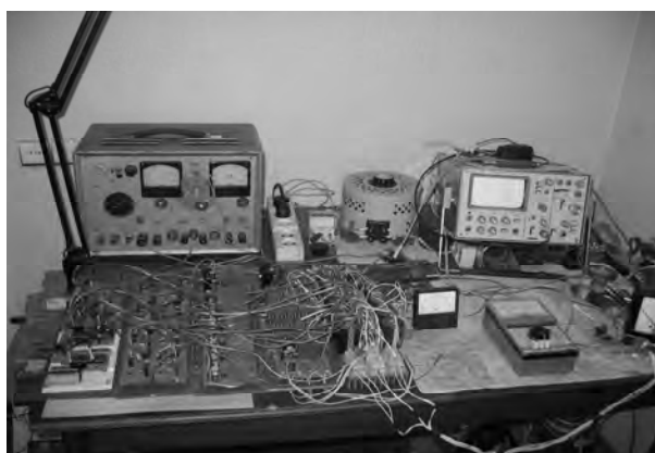
Рисунок 3.б – Лабораторный стенд линейного асинхронного регулируемого электропривода
