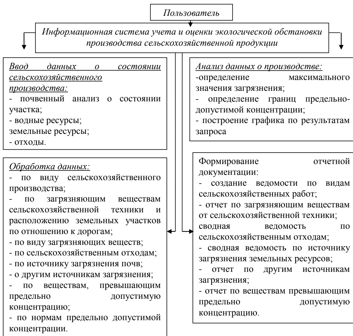
Рис. 1. Функциональная схема программного обеспечения экологически ориентированного управления производством сельскохозяйственной продукции
