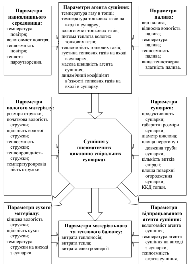
Рис. Структурна схема процесу сушіння стружки у пневматичних циклонно-спіральних сушарках
