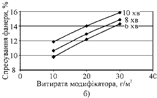
Рис. 5. Залежність спресування фанери: а) від часу пресування; б) від витрати модифікатора
