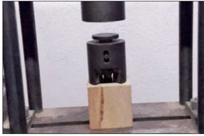
Рис. 6. Проведення експерименту на статичну твердість
