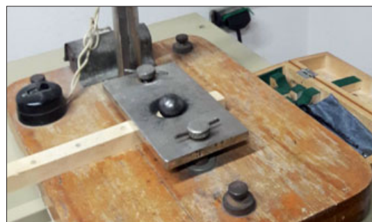
Рис. 4. Проведення експерименту на ударну твердість Fig. 4. Conducting an experiment on impact hardness
