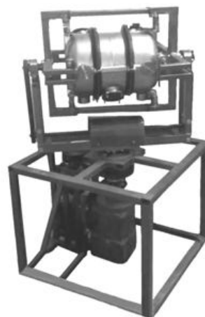
Рис. 1. Загальний вигляд експериментально-дослідного зразка вібровідцентрового дезінтегратора
