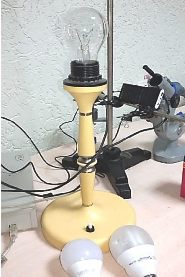
Рис. 2. Установка для дослідження ефекту миготіння ламп
