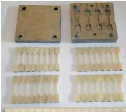
Мал. 2. Загальний вигляд форми і виготовлених зразків з кожного типу полімеру
