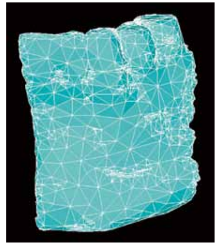
Мал. 7. Поверхнева сітка 3D моделі, згенерована в MIMICS і передана у ANSYS
