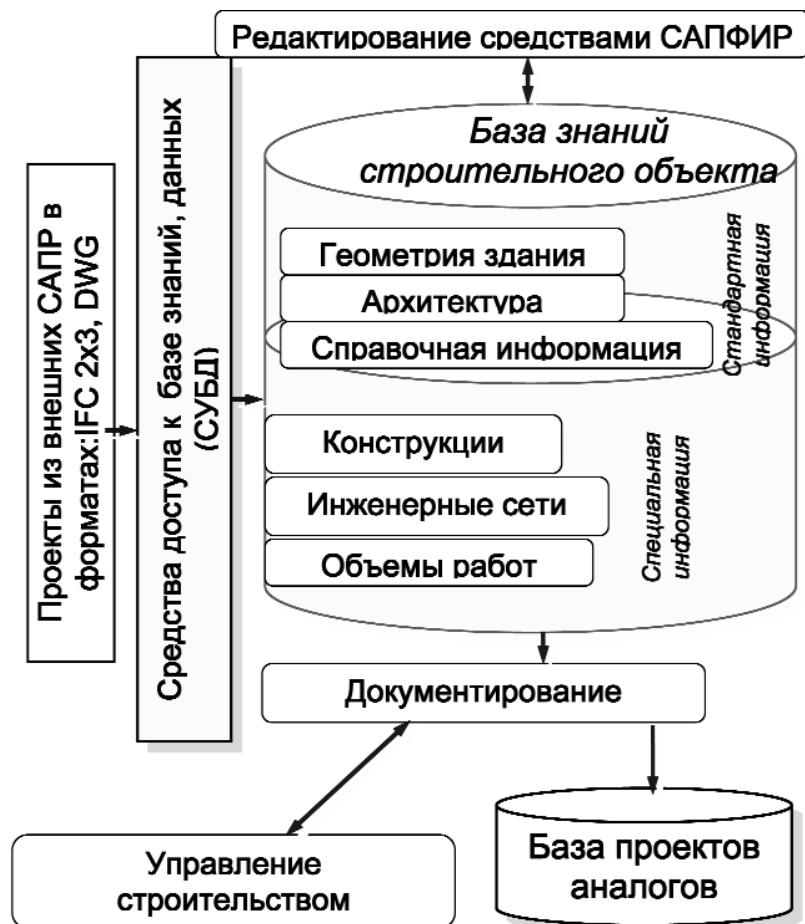
Рис. 2. Функциональная структура базы знаний строительного объекта
