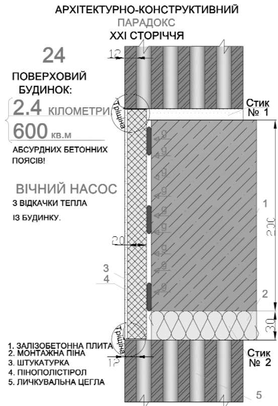
Рис. 3. Вузол стику стіни з перекриттям
