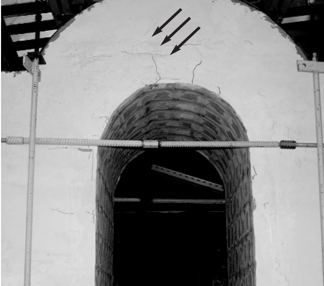
Рис. 7. Характер деформації отриманий під час першого етапу випробувань
