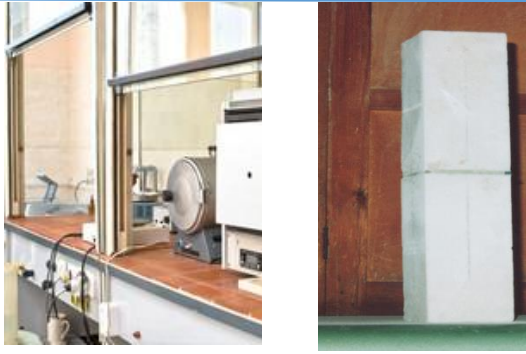
Рис. 2. Лабораторная печь и испытуемые образцы железобетонных конструкций, склеенных полимерными клеями.
