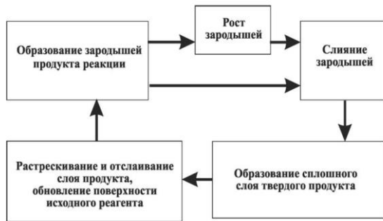
Рис.3. Последовательность стадий превращения твердого реагента
