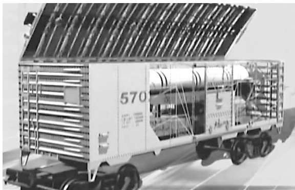
Рис. 1. Перевозка снаряженных корпусов твердотопливных ракетных двигателей РС-22 железнодорожным транспортом
