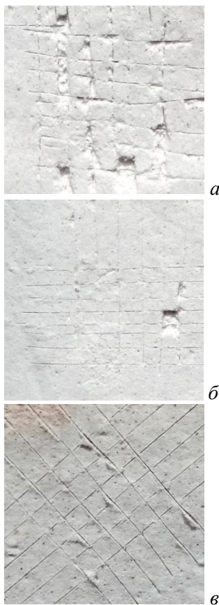
Рис. 5. Перевірка адгезійної міцності покриття до бетонної основи методом решітчастих надрізів: а – зразок №1 після випробувань, б – зразок №3 після випробувань, в – зразок №7 після випробувань.
