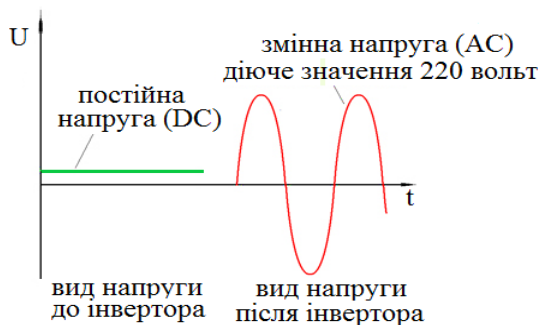
Рис. 6. Перетворення постійної напруги в змінну за допомогою інвертора
