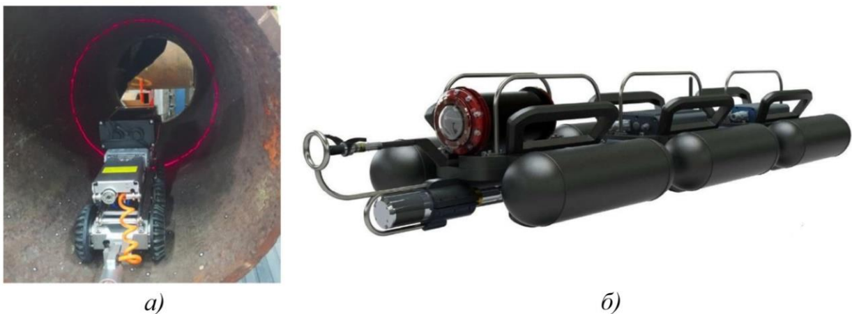
Рис. 2. Пристрої для лазерного сканування: а) на колісній базі; б) на повітряній платформі
