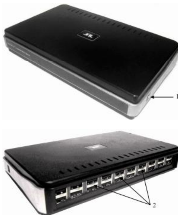
Рис.1. Зовнішній вигляд багатоканального приладу для вимірювання температури і теплових потоків: 1 – роз'єм для підключення персонального комп'ютера, 2 – роз'єми для підключення термоелектричних сенсорів температури і теплового потоку
