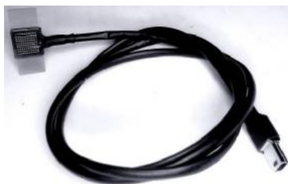
Рис.2. Зовнішній вигляд термоелектричного сенсора температури і густини теплового потоку
