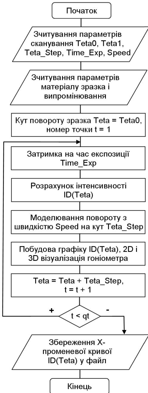
Рис. 6. Схема алгоритму розрахунку інтенсивності I_D(Teta) X-хвильової кривої.
