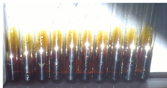
Рис. 4. Шкала порівняння для напівкількісного визначення гліцерину у темному пиві
