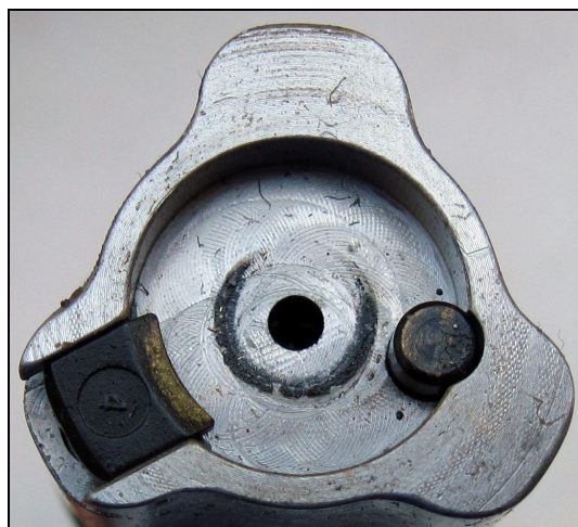
Рис. 9, 10. «Чашка» затвора карабіна та денце стріляної з нього гільзи
