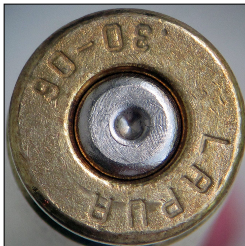
Рис. 9, 10. «Чашка» затвора карабіна та денце стріляної з нього гільзи
