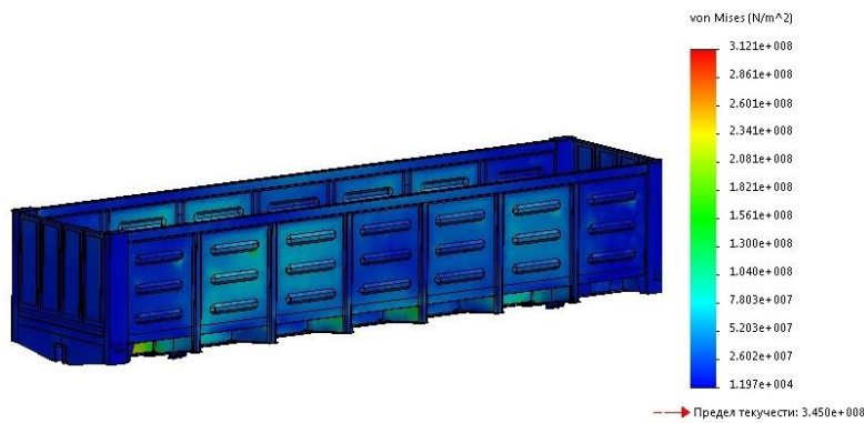
Рис. 6 Епюра навантажень при розтягненні, ривку III розрахунковий режим
