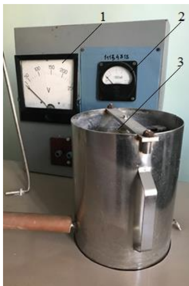
Рисунок 2 - Загальний вид лабораторної експериментальної установки: 1 – вольтметр; 2 – амперметр; 3 – ємність с мішалкою
