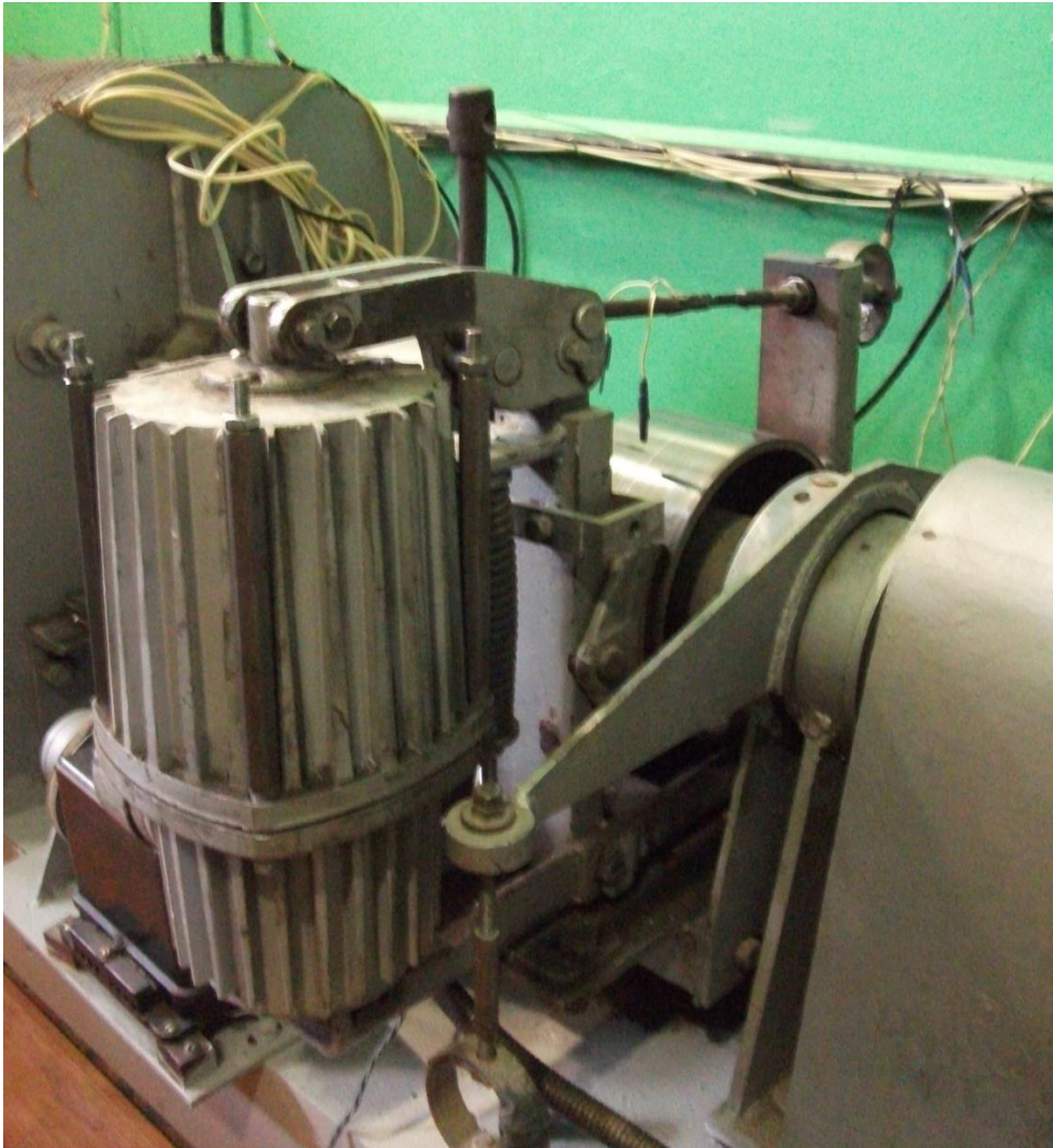
Рисунок 1 – Фото колодкового гальма ТКТГ-200 на дослідному стенді
