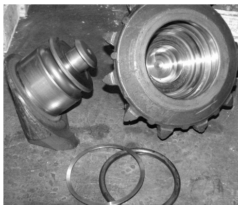
Рисунок 1 – Загальний вигляд елементів опори відпрацьованого бурового тришарошкового долота фірми „Hughes” 15 ½ VU-11 R325 (аналог 393,7 М-ГВУ-D34)
