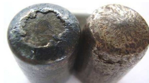
Рисунок 2 – Знос і деформація торців роликів з подальшим загостренням в основі
