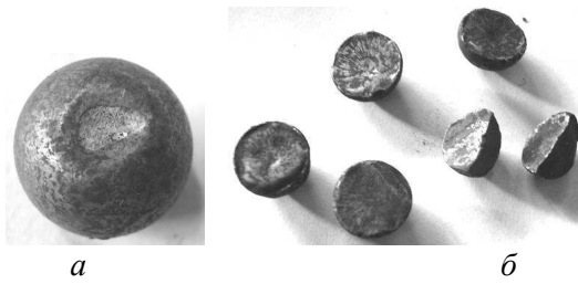
а – сколювання фрагменту; б – розколювання кульок навпіл і на декілька частин Рисунок 8 – Руйнування кульок замкового підшипника опори
