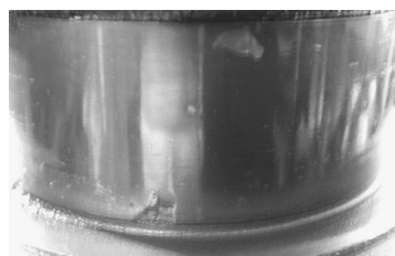
Рисунок 4 – Початкові контактні руйнування в навантаженій ділянці бігової доріжки периферійного роlikового підшипника опори долота
