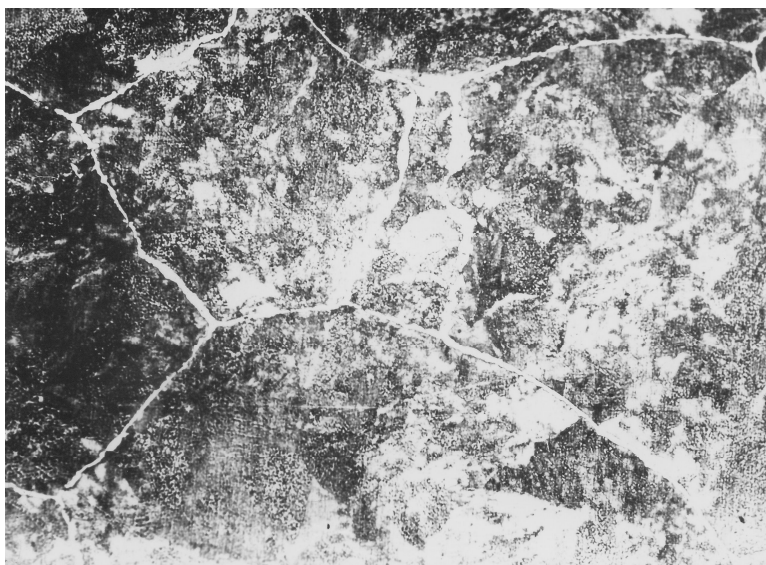
Рисунок 6 – Мікроструктура металу висадженого кінця бурильної труби
