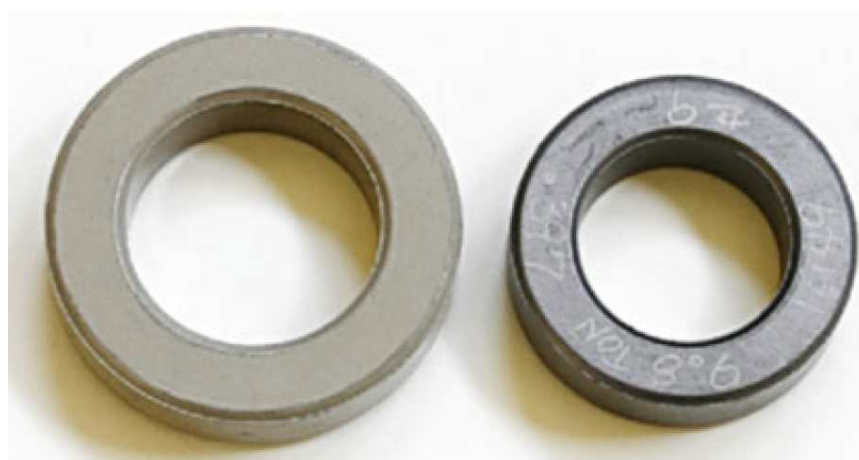
Рисунок 3 – Усадка SiC після твердофазового спікання
