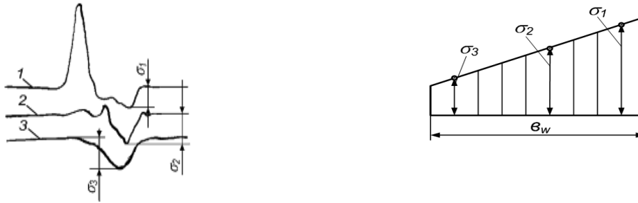
Рис. 3. Осциллограмма напряжений в основе безопасного зуба и эюра их распределения по ширине в начальный период (условные обозначения см. рис. 2)
