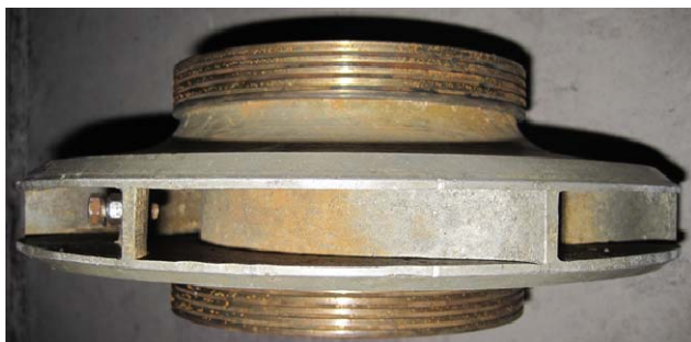
Рисунок 3 – Фото установа до робочого колеса насосу додаткової маси, що імітує потрапляння стороннього тіла та викликає додатковий дисбаланс
